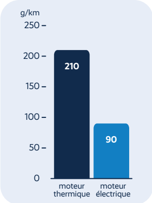
Émissions de CO 2 sur la durée de vie du véhicule (D'après une étude ADAC, décembre 2022)
