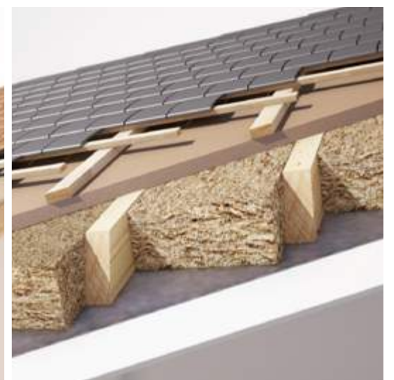
Dach nach der Renovierung (mit Dämmung)
